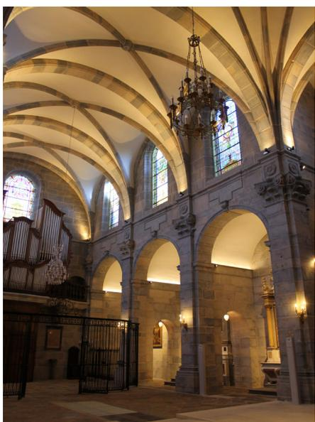
Une lumière chaude à leds d'une puissance de 900 W, installés par Innovelec, se substitue aux lampes incandescentes qui distribuait une faible lumière malgré leurs 4 KWh. Voûtes, doubleaux et chapelles latérales sont éclairés par de petits spots donnant une puissance plastique à l'architecture.
